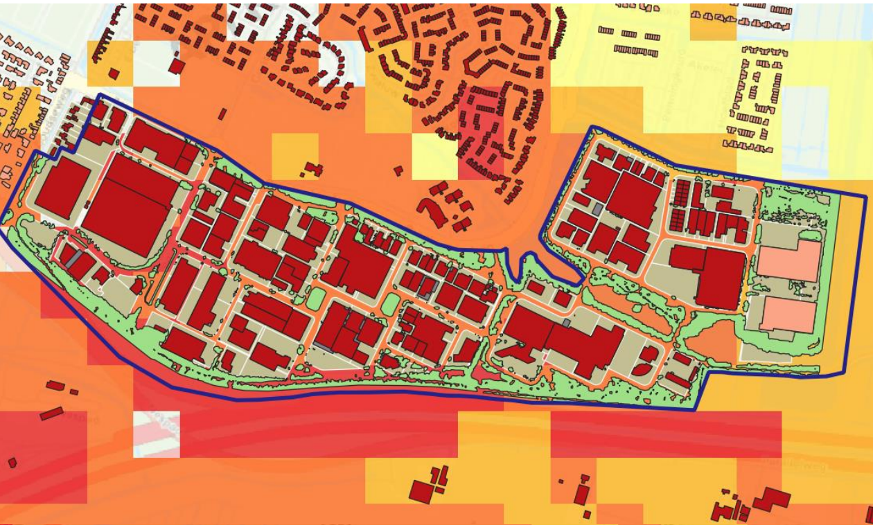
Verwachte bodemdaling: 20 – 40 cm
