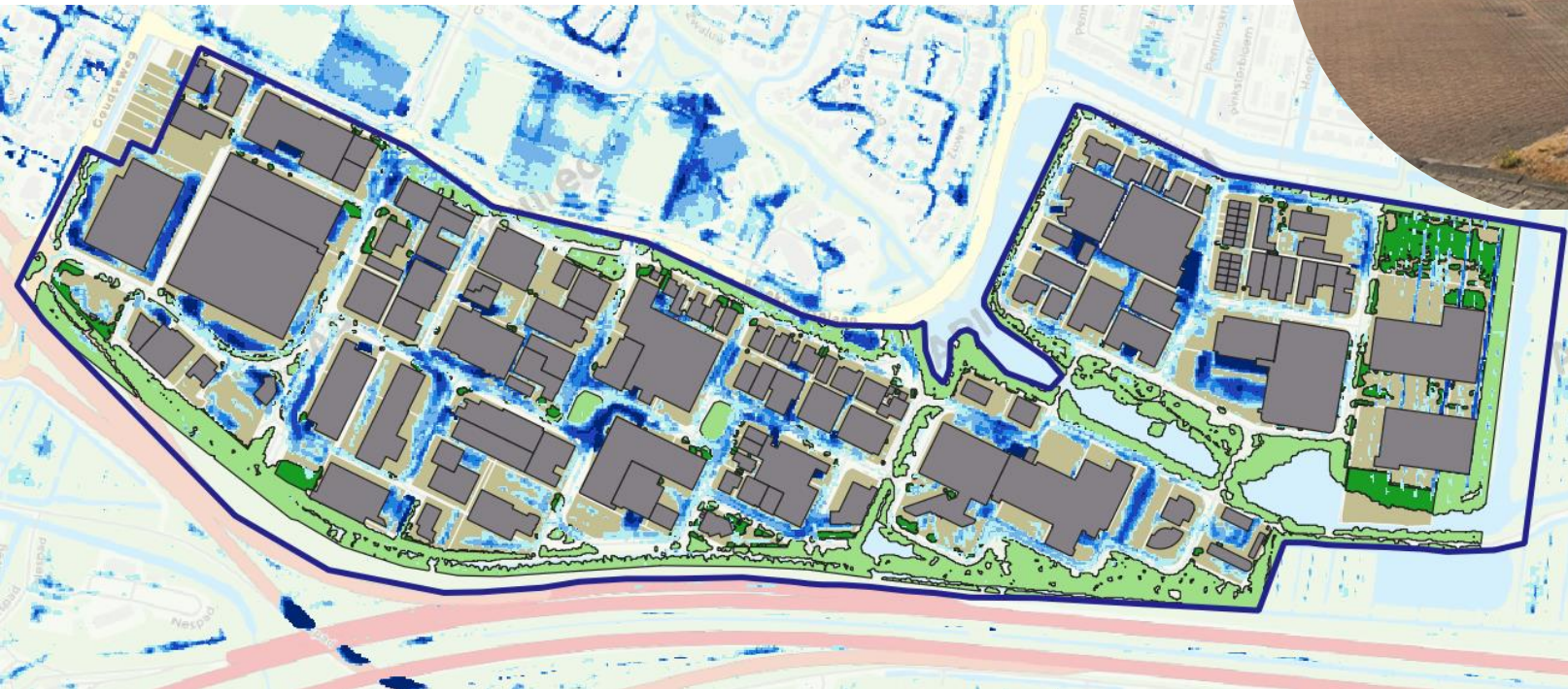
Waterdiepte op straat door hevige regenval (70 mm/2 uur)
